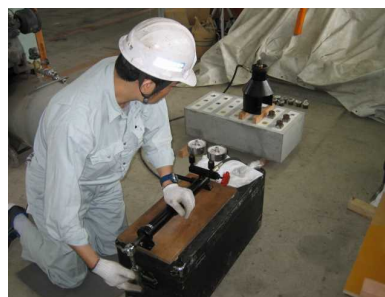
コンクリートとの付着強さ試験状況
