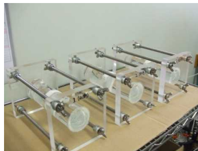
遮塩性試験状況
